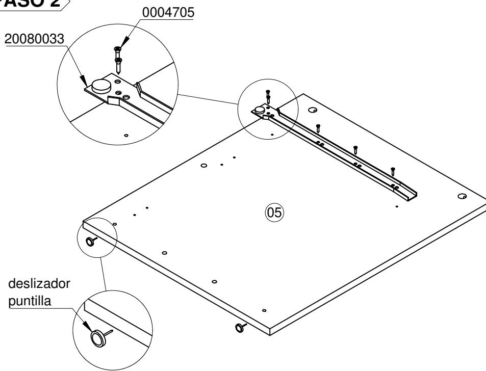
repetir proceso con la pieza # 06
